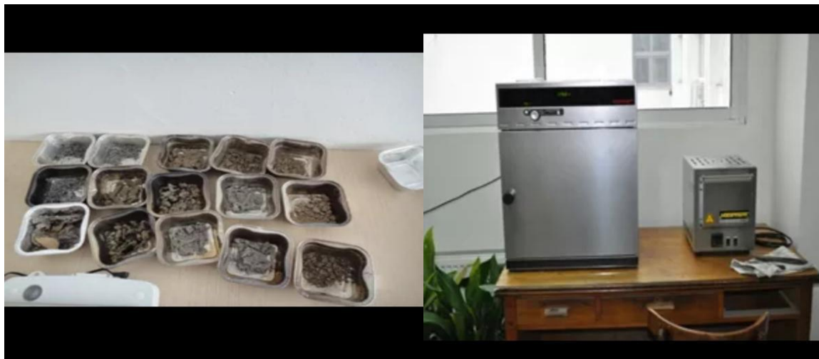
Figura 23. Pamje nga puna në laborator për përcaktimin e përqindjes së lëndës së thatë dhe të lëndës organike
